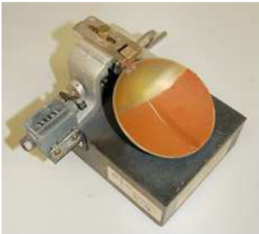
(a) Vista general de un dispositivo de Casagrande estándar
