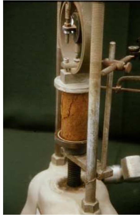
(b) Muestra ensayada con plano de rotura
