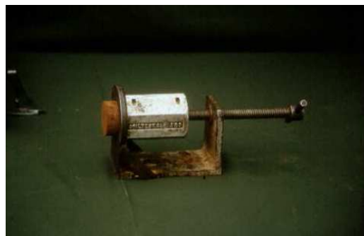
(c) Equipo para la extracción de la muestra compactada
