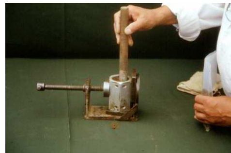
(b) Compactación del material
