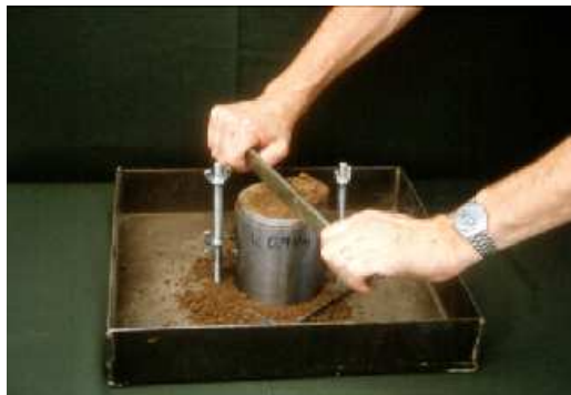
(a) Nivelación de la superficie del suelo
