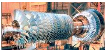
Calcul thermo-mécanique non linéaire d'un compresseur de turbine à combustion : rotor aubagé et quart-compresseur.
