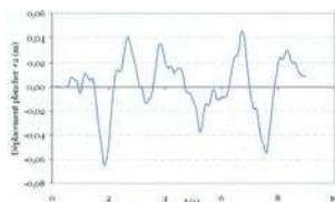
Déplacement du plancher #2 au cours du séisme.
