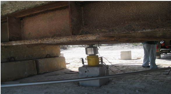
Figura 2. Preparación de una de las pruebas de cargas
