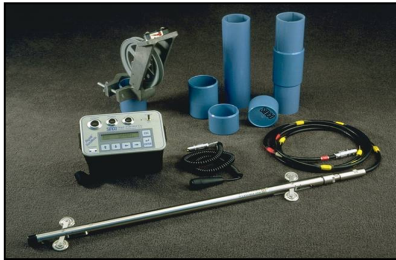
Figura 9. Equipos utilizados en mediciones de inclinometría
