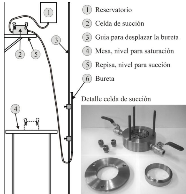
Figura 4. Placa de succión y componentes.
