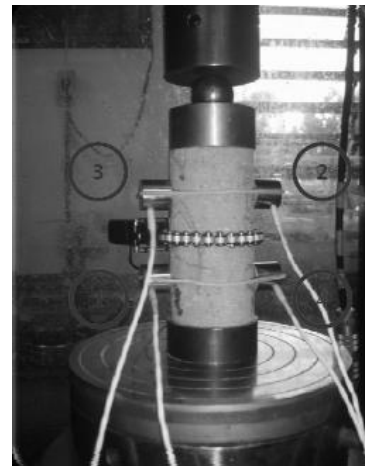
Figura 6. Cuerpo de prueba cilíndrico extraído de cuerpo de prueba prismático monitoreado con 4 sensores de emisión acústica y un extensómetro radial.
