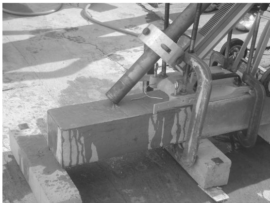
Figura 5. Esquema del equipo para la extracción de los cuerpos cilíndricos con inclinación de 45° en cuerpos prismáticos.
