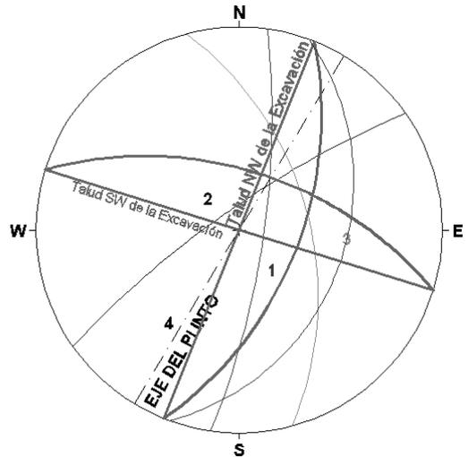
Figura 18. Estereograma general de los taludes de la excavación del muro de reposición del plinto
