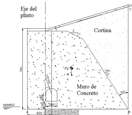
Figura 10. Sección del muro de reposición
