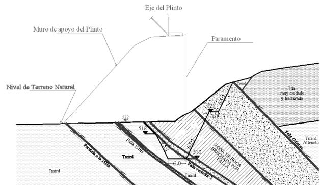
Figura 15. Sección transversal máxima del muro con excavación.
