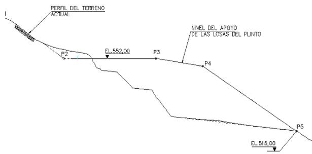
Figura 9. Sección a través del eje del plinto con topografía general, nótese la diferencia de niveles
