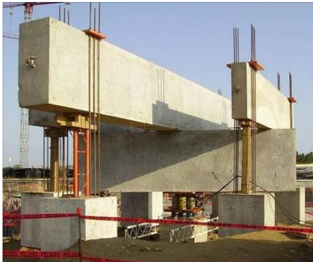
Figura 10. Sistema de reacción para las pruebas de compresión axial
