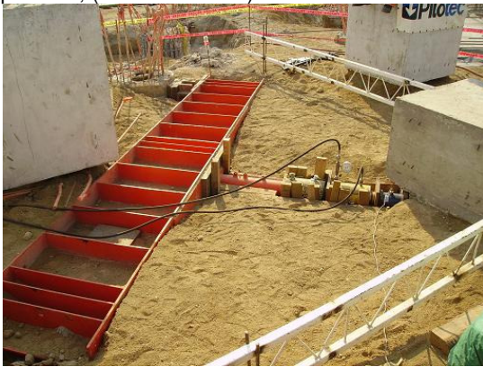
Figura 12. Arreglo general de prueba lateral
