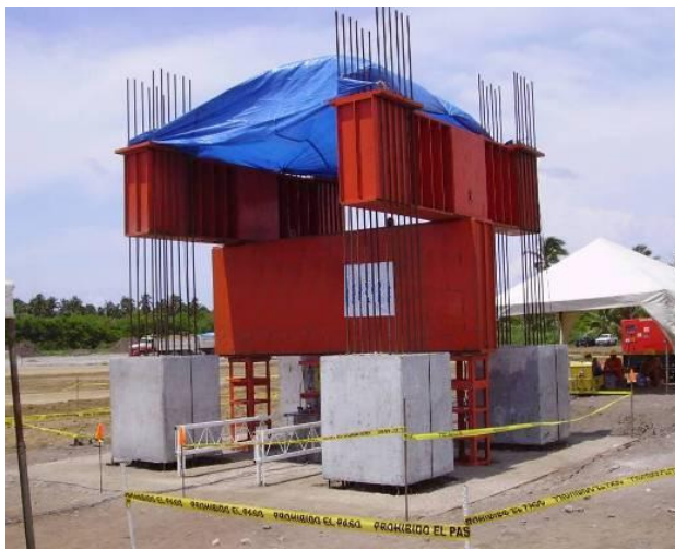
Figura 5. Arreglo de pruebas de carga a compresión
