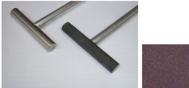
Figura 3. Penetrómetros mini T-bar del laboratorio 3S-R, con superficie lisa y rugosa (a), papel lija utilizado para obtener una superficie rugosa (b).
