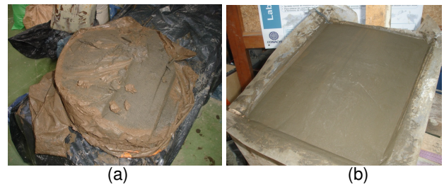
Figura 5. Arcilla natural BHM14 de aguas profundas (a) instalada en un cajón de madera (b) para visualización de mecanismos de falla.
